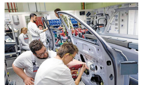
Auszubildender Esad Genc (links) und Tristan Hekler, Schüler der Astrid-Lindgren-Schule, schrauben gemeinsam an einer Übungstüre. In der Montage-Lernstation werden Leitungssätze verlegt und Fensterheber eingebaut.
